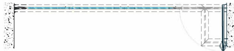
2 · Levantar pasadores (dos por panel). Los paneles abatibles con mecanismos de puerta no llevan pasador a suelo ya que se fijan mediante manivela-cerradero.
