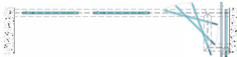
4 · Posición final. El panel abatible puede colocarse a uno u otro extremo del tabique admitiendo el sistema hasta dos paneles abatibles en un mismo tabique..
